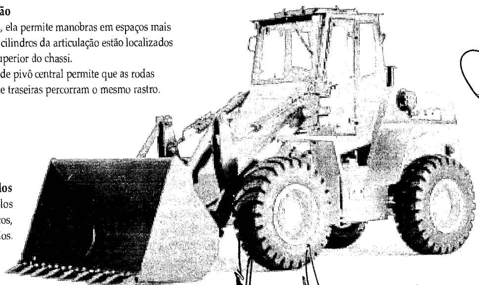
Acumulador de nitrogênio Mantém a eficiência do freio com o motor parado.
